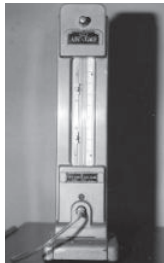
高圧流量式 空気マイクロメータ (1952)
