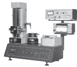
真円度・円筒形状測定機 RONDCOM 5A (1979)
